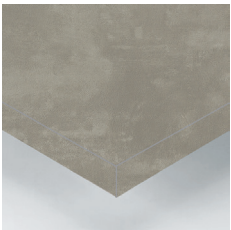
A2-...-16 Vorderkante mit PP-Anleimer 1,5 mm stark. 2 x R = 2 mm
